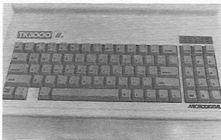
Detalhe do teclado do TK3000 IIe, notando-se o teclado numérico reduzido e acima dele os indicadores luminosos de estado.
